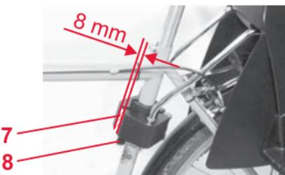
☞ Überprüfen Sie den Spalt an der Verschraubung **7**. Er muß 8 mm betragen damit die Bügelenden sicher einrasten.
