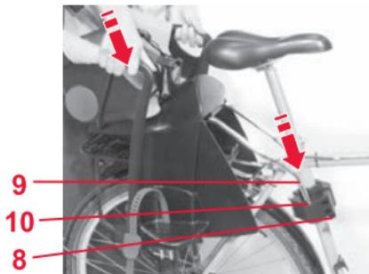
☞ Inserite il seggiolino da bicicletta con le staffe di fissaggio **9** nei fori di arresto **10** finché si blocca.
