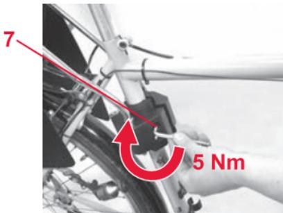
☞ Ziehen Sie nun die Schrauben **7** der Halterung **5** mit einem Innen-Sechskant-Schlüssel (Größe 5) mit einem Drehmoment von 5 Nm fest.
